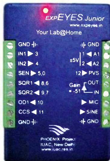
Zařízení ExpEYES projektu PHOENIX
