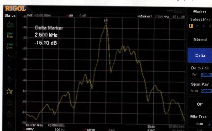
Obr. 23. Zdvih FM modulace modelářského vysílače v detailu
